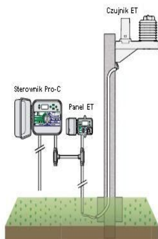
Czujnik ET można w prosty sposób przymocować do pala bądź ściany w odległości 30 metrów od Panelu ET.
