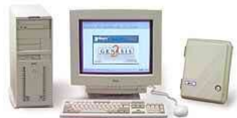
Ilustracja 2. Możliwe jest rozbudowa sterownika tak, aby można było sterować nim z komputera centralnego.
